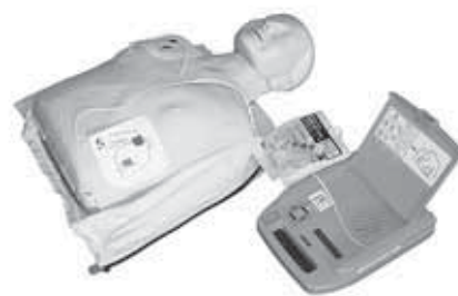
AED 心臓に電気ショックを与え、正常なリズムに戻すための医療機器。
